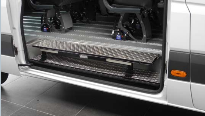
Die hochgeklappte Trittstufe ist mit dem Fahrzeugboden eben.
