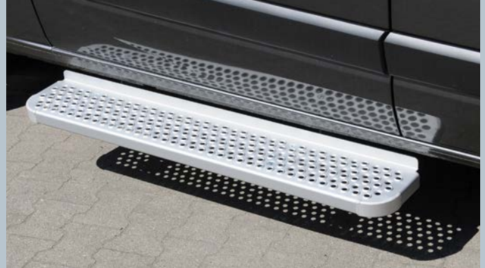
Untergebaute Trittstufe bei geschlossener Tür.
