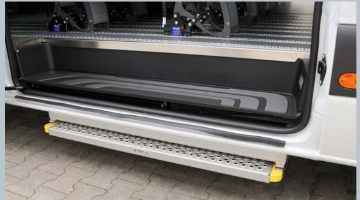
Trittstufe in Ruhestellung unter dem Fahrzeug montiert.
